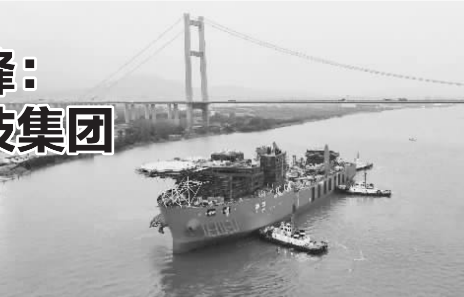
天海防务旗下大津重工镇江基地建造的5000吨级起重打捞工程船
