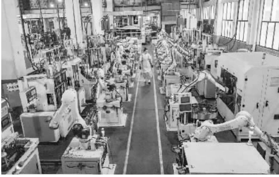
在浙江省永康市浙江飞剑集团有限公司数字化工厂智能生产线上,工业机器人正在加工保温杯(无人机照片)。
