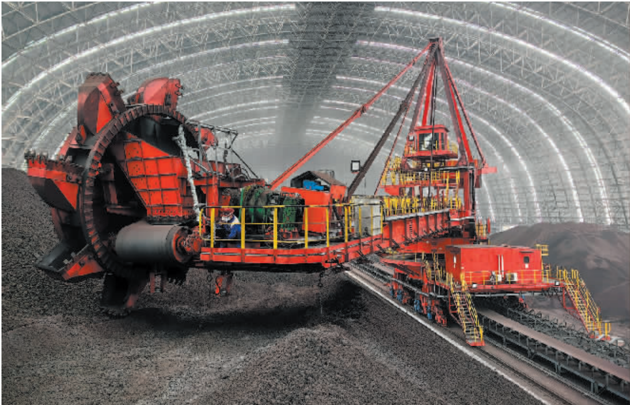
大连重工装备集团为太行钢铁集团生产的取料机
