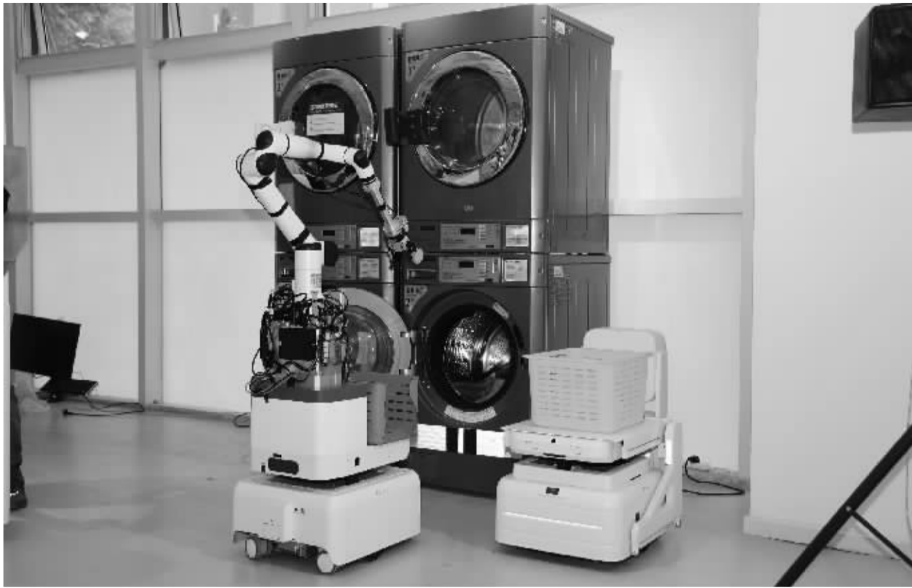
单臂协作机器人抓取脏衣服放入洗衣机，左为单臂协作机器人，右为收衣服机器人。 本报记者 郑萃颖 摄
