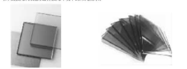
欧洲灰玻璃 福特蓝玻璃 翡翠绿玻璃:外观呈温润的绿色(浅绿至深绿),贴近自然色调,视觉舒适;透光率约40%-60%,能过滤部分紫外线和红外线,兼具遮阳和装饰效果;绿色调可与室外绿植、自然环境融合,增强建筑与环境的协调性。 茶色玻璃:以氧化铁和氧化锰为主要着色剂,呈温暖的棕褐色,透光率较低(20%-40%),隐私性强,常用于浴室、办公室隔断。 宝石蓝玻璃:比福特蓝更深邃的蓝色,着色剂浓度更高,透光率约25%-40%,装饰性强,适用于高端建筑外立面。
