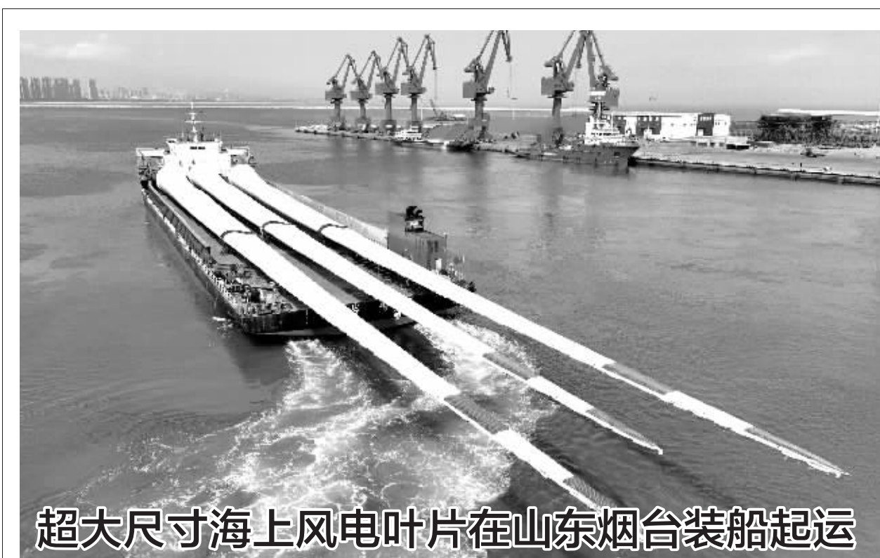
超大尺寸海上风电叶片在山东烟台装船起运 8月1日，超大尺寸海上风电叶片从山东港口烟台港蓬莱港区起运（无人机照片）。 8月1日，三支超大尺寸海上风力发电机试验叶片在山东港口烟台港蓬莱港区完成装船并运往试验基地。该型叶片长达153米，重83.5吨，属于150米级超大尺寸海上风电叶片，现已完成全部静力测试，即将在试验基地进行疲劳测试验证。 新华社图文
