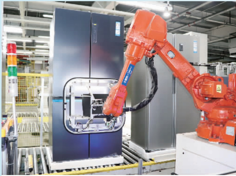
海尔青岛冰箱互联工厂的AI视觉检测系统
