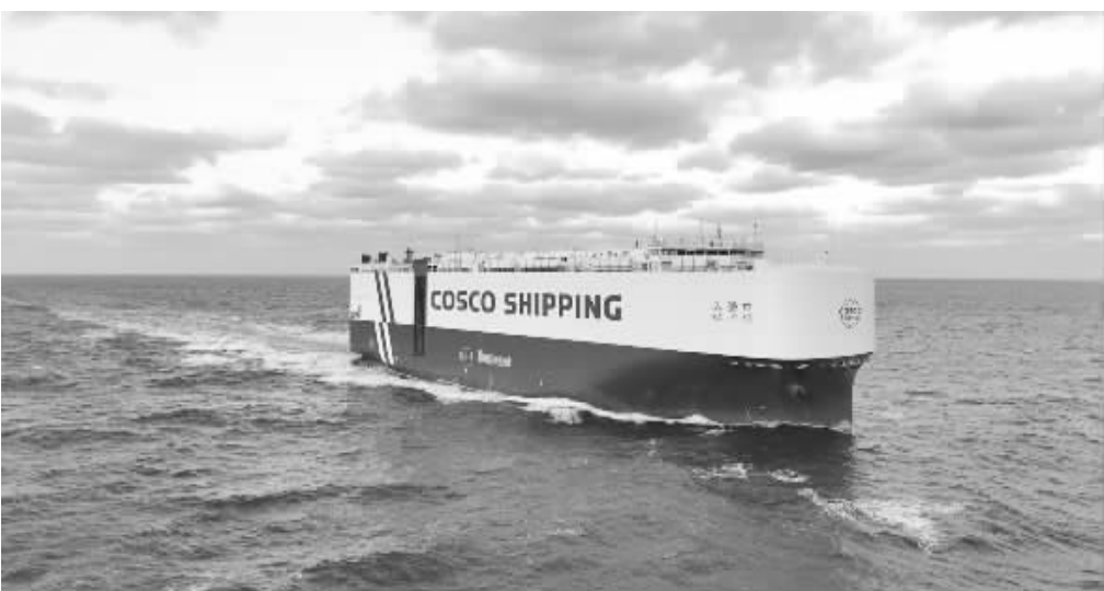
8600车位LNG双燃料动力大型汽车运输船系列首制船（PCTC）“文景口”号 公司供图
