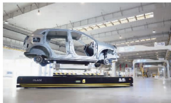
国机汽车旗下中汽工程开发的智能化岛式装配系统
