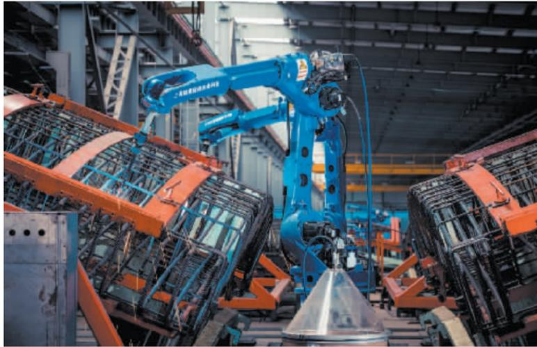
隧道股份海盐制造工厂的管片钢筋骨架示教型自动焊接系统
