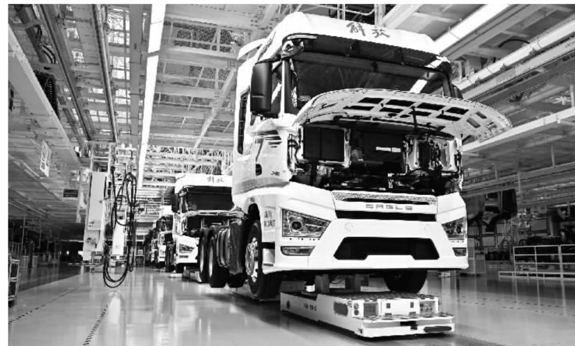
一汽解放汽车有限公司J7智能工厂内,AGV搬运机器人搬运卡车等待下线。
