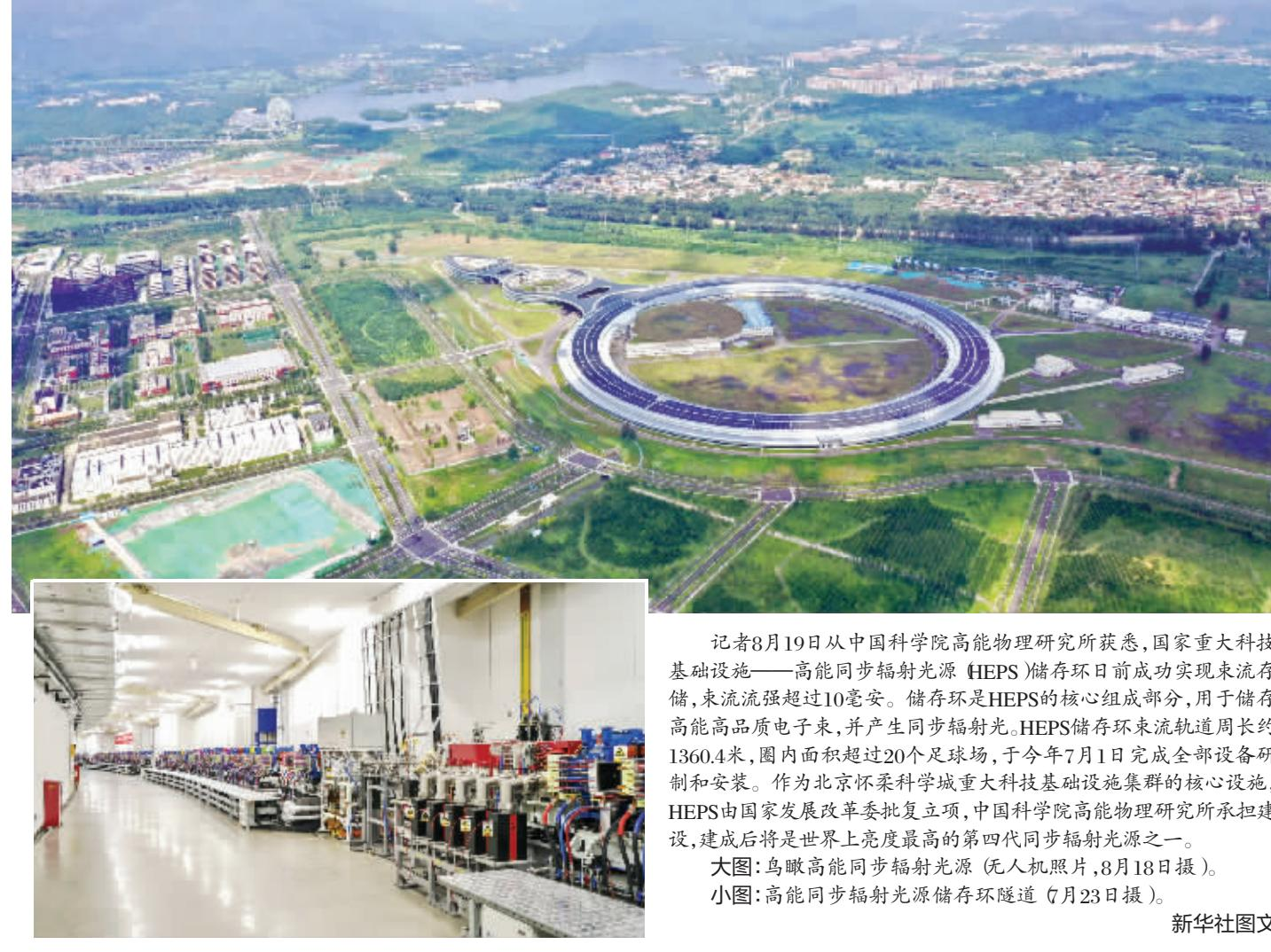
记者8月19日从中国科学院高能物理研究所获悉,国家重大科技基础设施——高能同步辐射光源(HEPS)储存环日前成功实现束流存储,束流强度超过10毫安。储存环是HEPS的核心组成部分,用于储存高能高品质电子束,并产生同步辐射光。HEPS储存环束流轨道周长约1360.4米,圈内面积超过20个足球场,于今年7月1日完成全部设备研制和安装。作为北京怀柔科学城重大科技基础设施集群的核心设施,HEPS由国家发展改革委批复立项,中国科学院高能物理研究所承担建设,建成后将是世界上亮度最高的第四代同步辐射光源之一。
