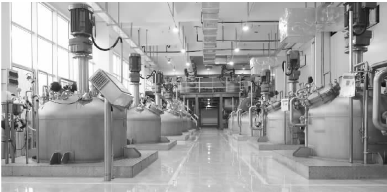
富祥药业子公司富祥生物的微生物蛋白生产车间发酵区
