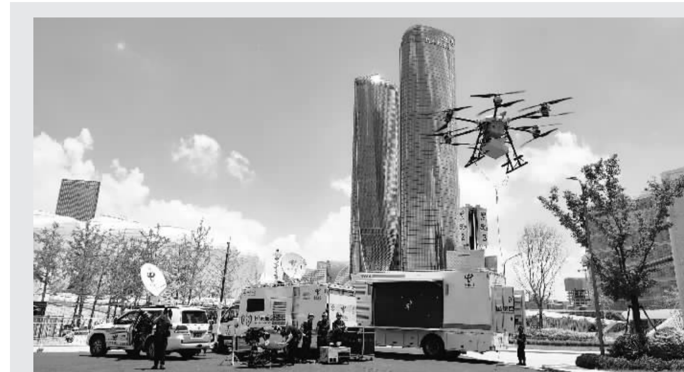
中国电信部署在杭州亚运会主体育场“大莲花”外的应急通信保障装备，一架无人机基站正在起飞。
