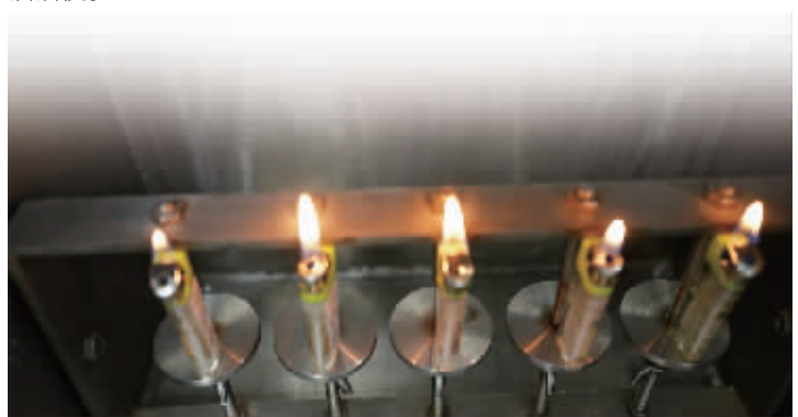
打火机正在进行“爆火、跳火”检验。
