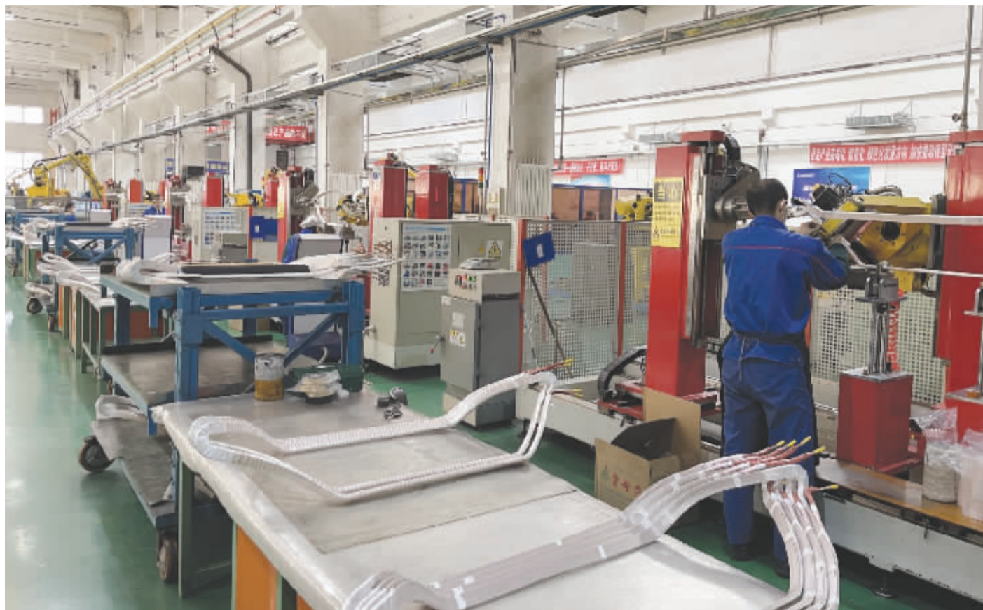
图为佳电股份电机车间云母带自动缠绕机
