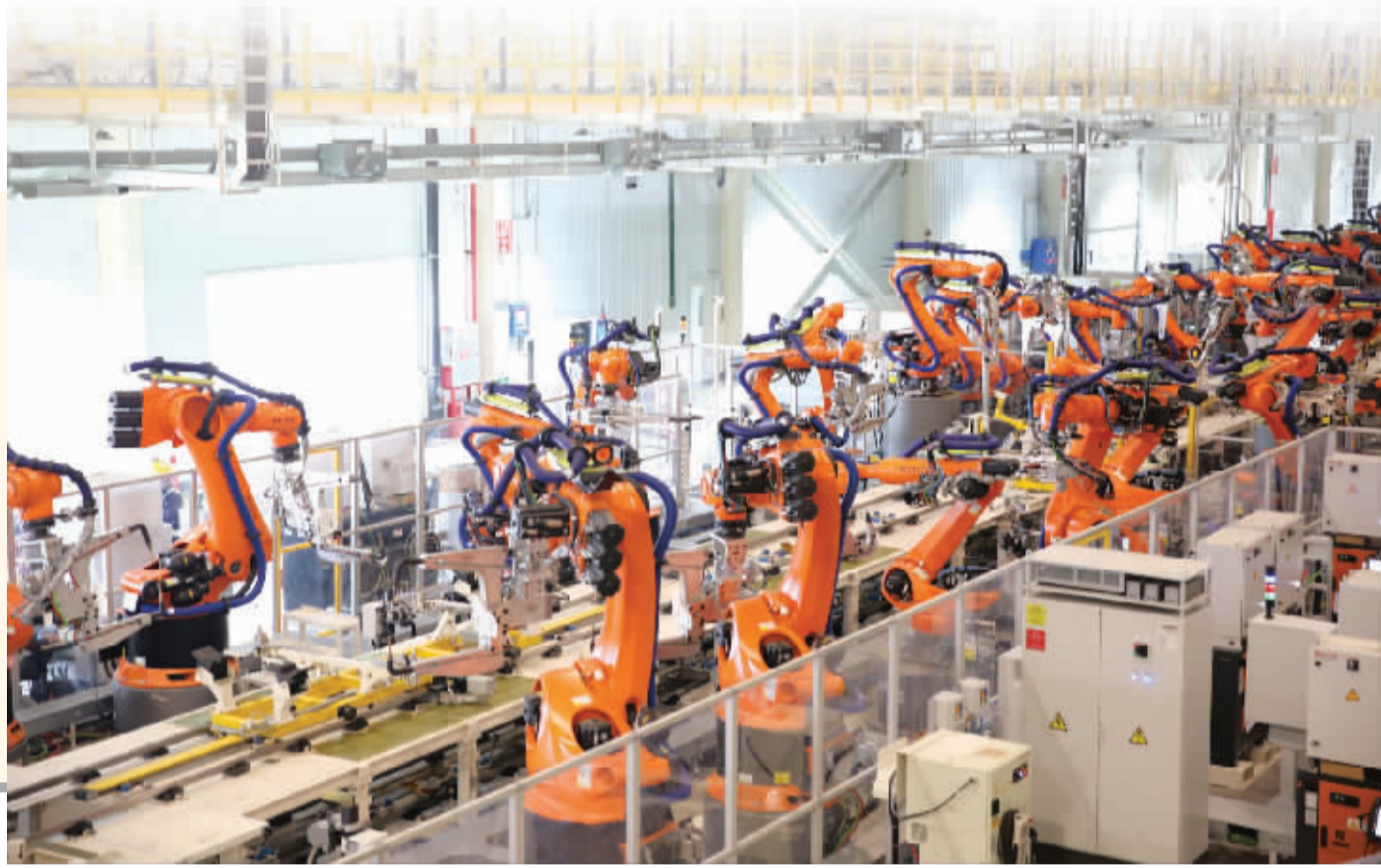
瑞松科技汽车智能制造柔性焊装产线。
