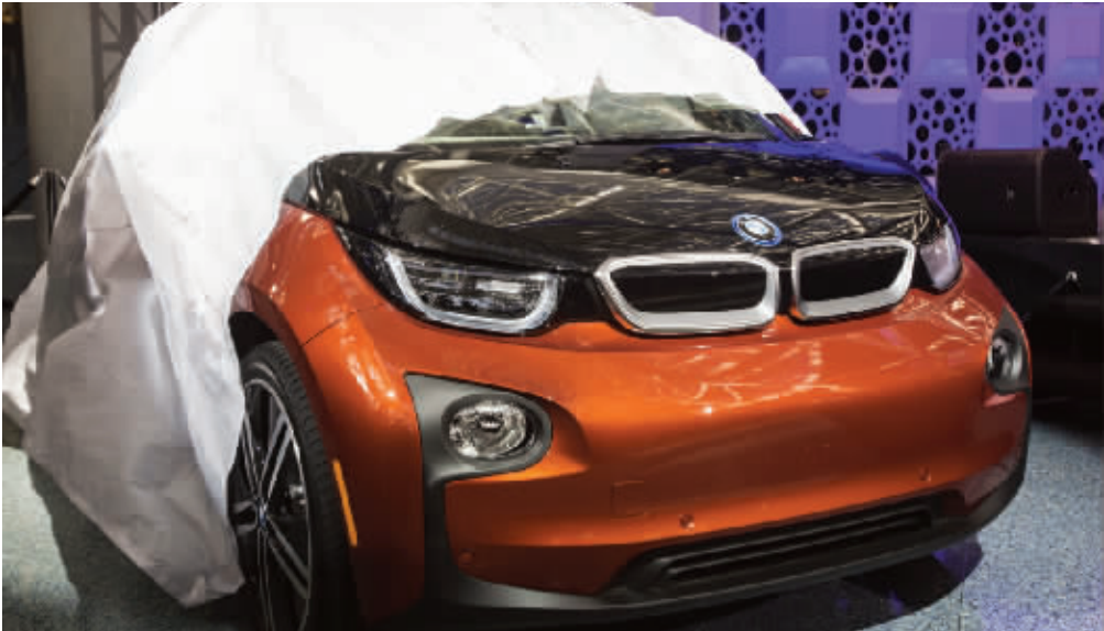
宝马i3在全铝车身框架结构的基础上使用了轻量级的碳纤维增强塑料车身。
