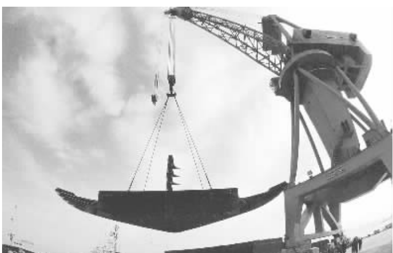
△浙江一造船厂正在吊装船舶分段。
