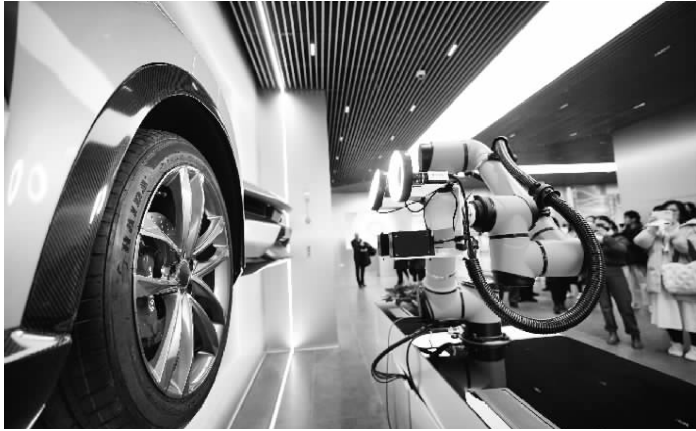
机械臂正在进行车轮部件自动化检测。
