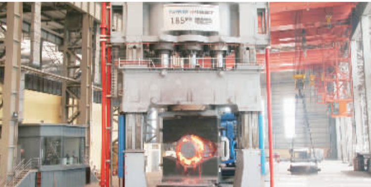
中信重工的18500吨自由锻造油压机组
