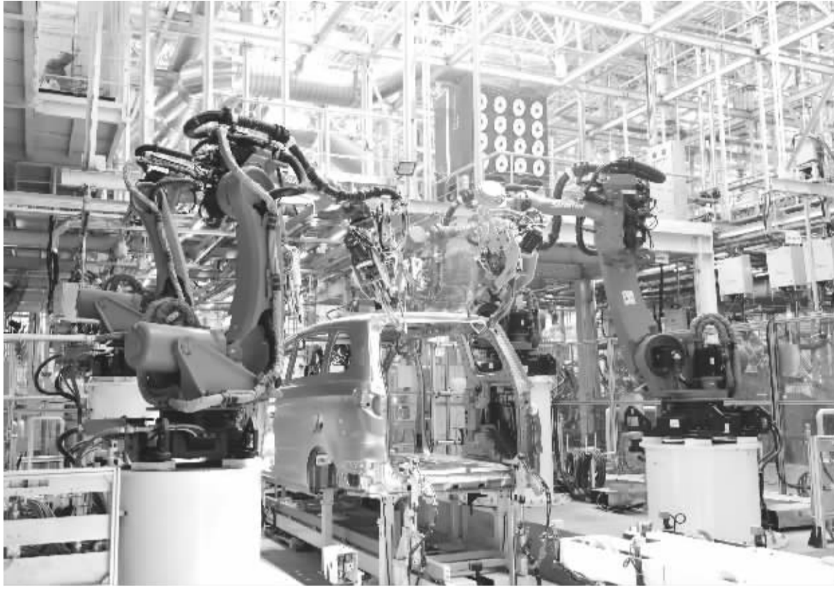
新松机器人汽车生产线焊接应用现场。
