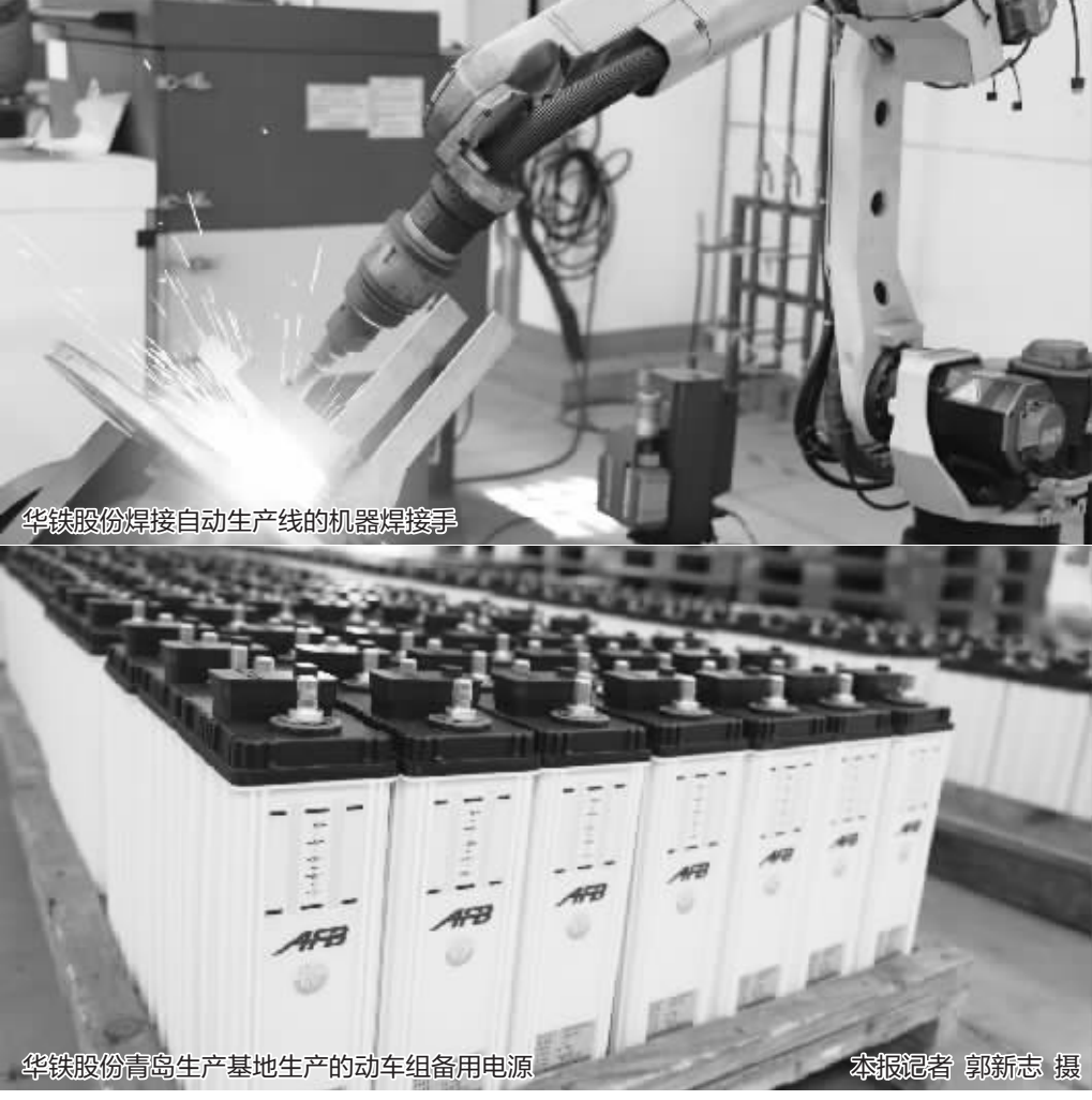
华铁股份青岛生产基地生产的动车组备用电源
