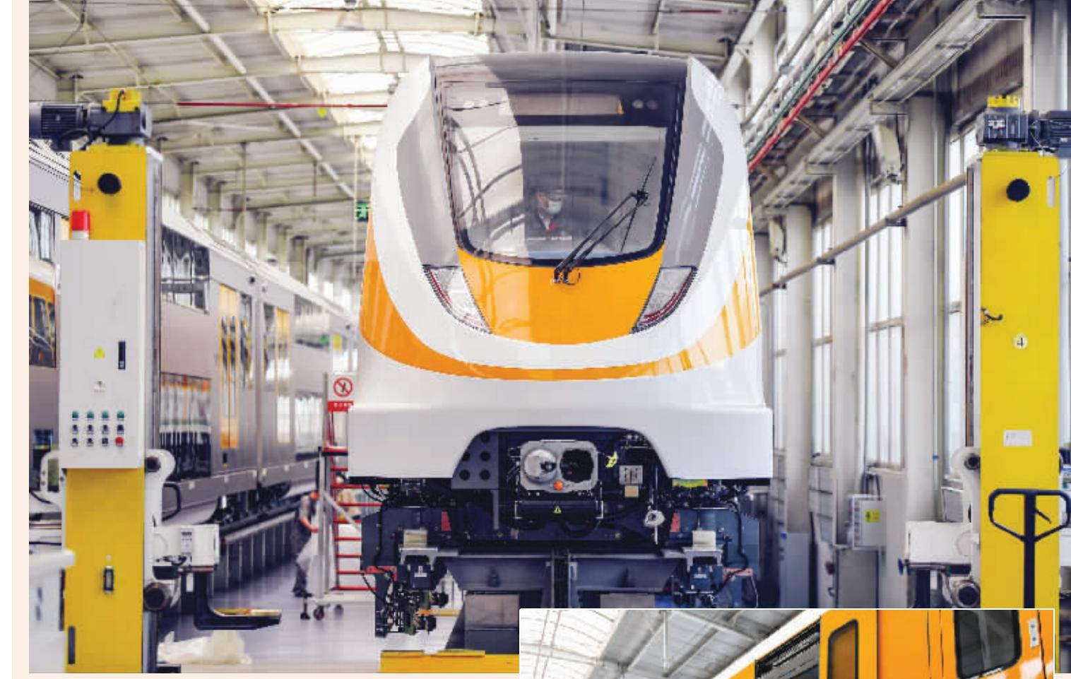
中车长客研制的新型磁浮列车进入整车调试阶段
