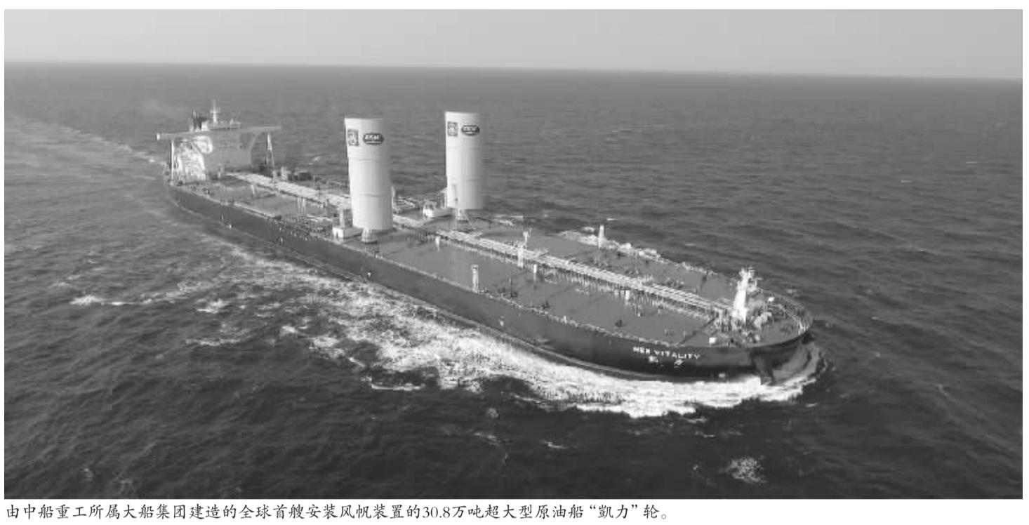
由中船重工所属大船集团建造的全球首艘安装风帆装置的30.8万吨超大型原油船“凯力”轮。
