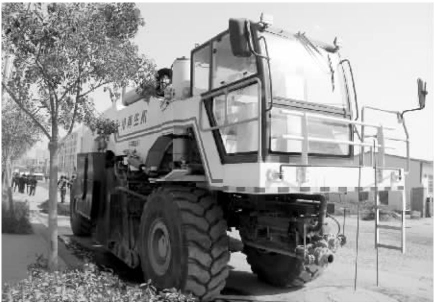
达刚路机生产的冷再生机。
