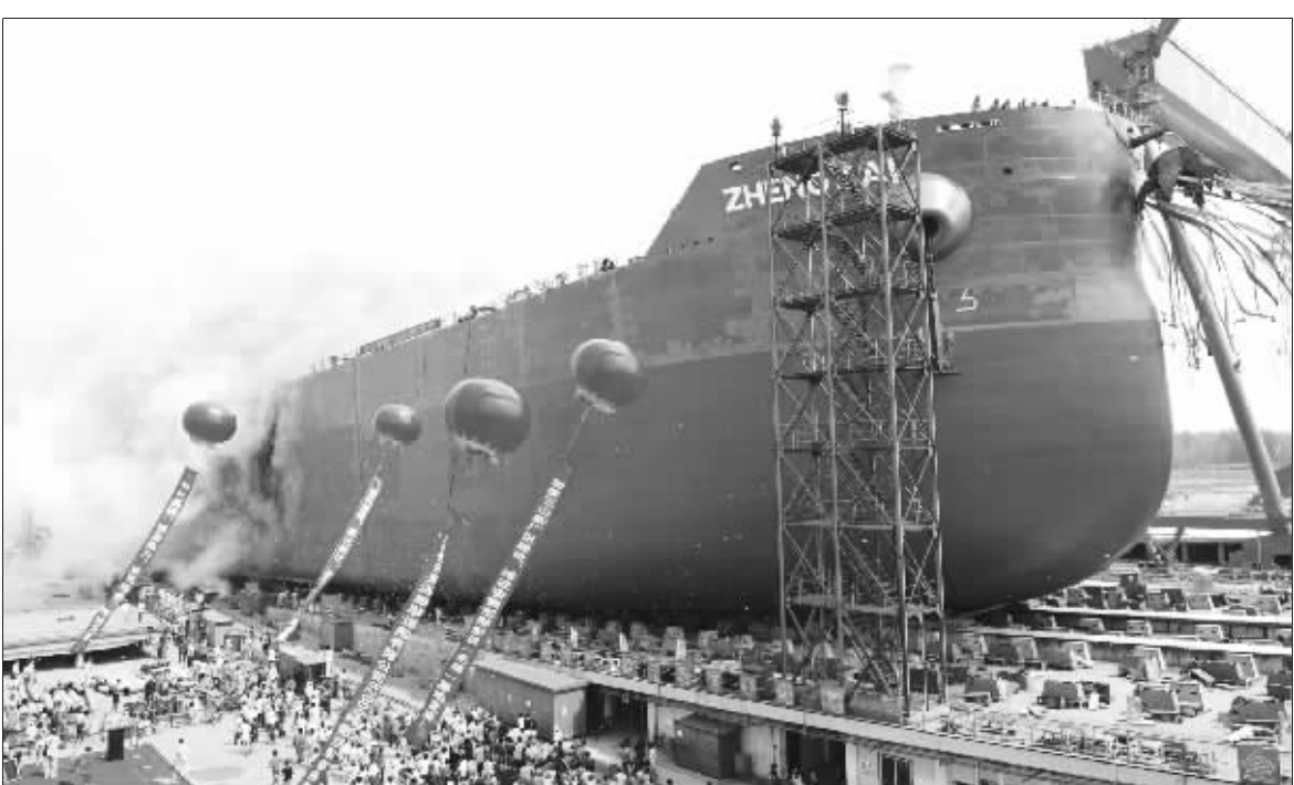
8月16日,一艘8.2万吨散货船在芜湖新联三山新厂区下水。当日,安徽芜湖新联造船有限公司为福建远洋运输有限公司批量建造的第一艘8.2万吨散货船在芜湖新联三山新厂区顺利下水。该船型长229米,型宽32.26米,型深20.05米,为安徽迄今承建的最大吨位远洋船舶。
